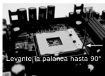
PASO 1: Levante la palanca del zócalo hasta 90°
