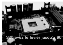
ÉTAPE 1 : Soulevez Le Levier de Douille Jusqu'à 90°
