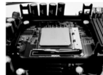
ÉTAPE 4 : Abaissez et Fermez Le Levier de Douille
