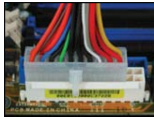
20 érintkezős tápcsatlakozó (a 24 érintkezős hüvelyen)
