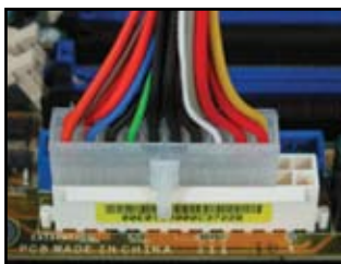
20-pinowe złącze zasilania (na 24-pinowym złączu żeńskim)
