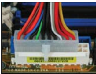
Conector de alimentação de 20 pinos (encaixa na ranhura do conector de 24 pinos)
