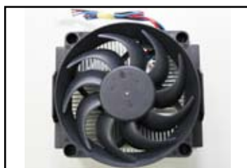
Радиатор и вентилятор, вид сверху
