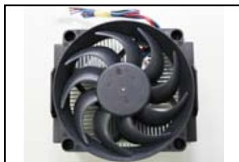
Pogled odozgo na rashladni profil i ventilator
