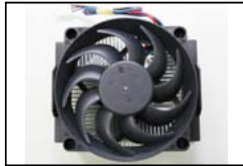
Isı emici ve fan üst görünümü
