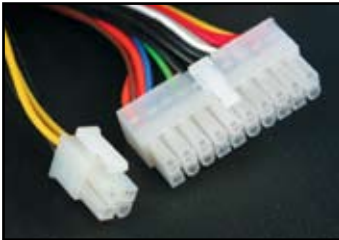
conector de alimentación periférico (izquierda) conector de alimentación de disquetera (derecha)
