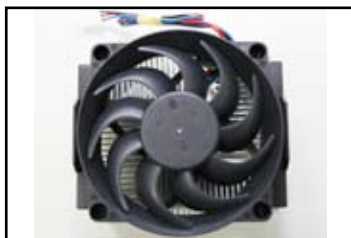
Поглед към радиатора и вентилатора отгоре
