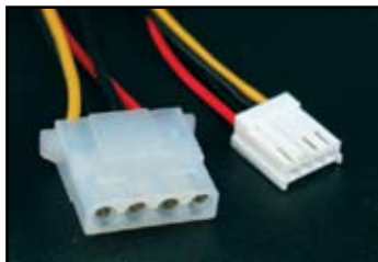
Periferni konektor za struju (levo) Konektor za struju za flopi (desno)
