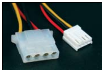
konektor periferního napájení (vlevo) konektor napájení disketové jednotky (vpravo)
