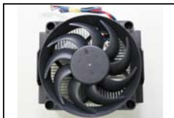
Pohled shora na tepelnou jímku a ventilátor
