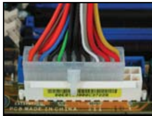
conectorul de alimentare cu 20 de portizolatori (pe conectorul mamă cu 24 de portizolatori)
