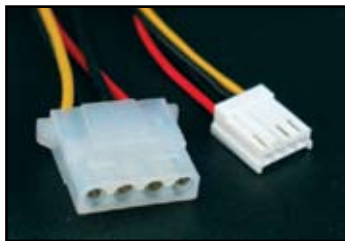
Разъем питания для подключения периферийных устройств(слева) Разъем питания дисковода (справа)
