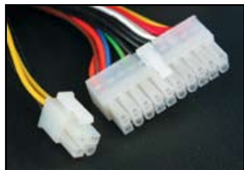
konektor periferního napájení (vlevo) konektor napájení disketové jednotky (vpravo)
