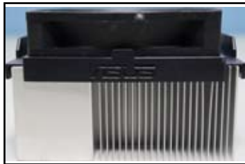
Vedere laterală a radiatorului și a ventilatorului
