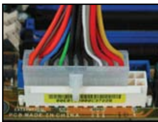
20kolíkový konektor napájení (na 24kolíkové zásuvce)
