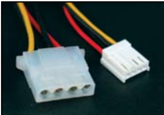
conector de alimentación periférico (izquierda) conector de alimentación de disquetera (derecha)
