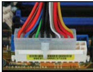
Connettore di alimentazione a 20-pin (sulla controparte femmina a 24-pin)
